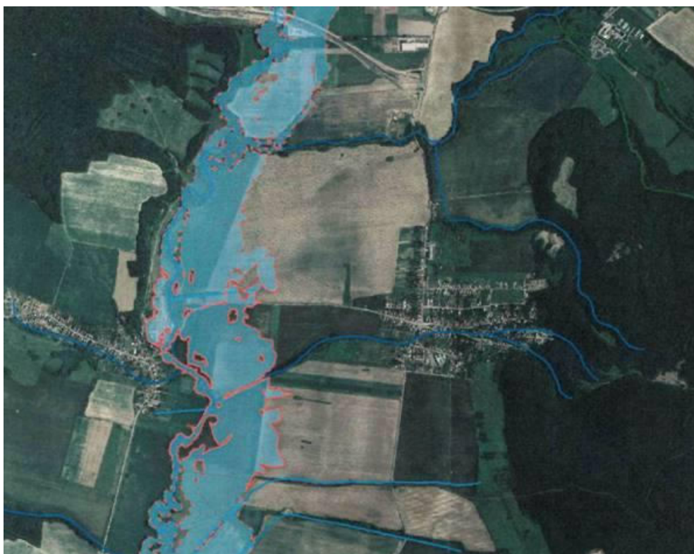
Obrázok 10: Priebeh orientačnej záplavovej čiary na rieke Olšava pre prietok Q100.
